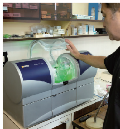
▲セレック (セラミックの詰め物や被せ物を作成する機械)
